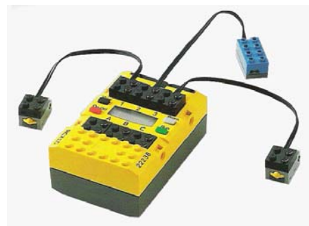
Figura 5. Conexión de sensores
