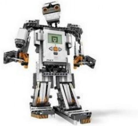
Entre los componentes del kit de montaje se distingue que el NXT de LEGO cuenta con un ladrillo microprocesador de 32 bits, una pantalla de matriz grande. Además dispone de 4 entradas y 3 puertos de salida, y comunicación por Bluetooth y conexión USB.
