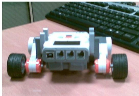
A continuación se coloca la rueda trasera, que servirá de estabilizadora para el movimiento, y también el sensor de color. El cual se conecta en el NXT a través del puerto 3.
