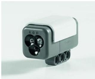
Una de las utilidades que se le puede dar a este sensor, y que será la empleada en el proyecto, será la de seguir una línea de un determinado color. Otro uso posible sería el de reaccionar de una determinada manera dependiendo del color que se detecte. La otra manera en la que se podría emplear este sensor sería la de indicador luminoso, dándole así un punto extra de personalidad.
