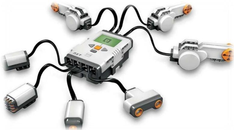
El ladrillo puede disponer de hasta 4 sensores y controlar hasta tres motores, por medio de tomas RJ12. Las cuales son muy similares, pero incompatibles, a las del cable telefónico.
