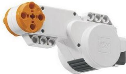
El sensor de rotación también permite fijar distintas velocidades al motor, cambiando el parámetro potencia (power). También permite girar el motor unos grados determinados.
