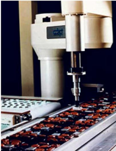
**Imagen 1.1** Robot industrial usado para empacar. <sup>[IMG 1]</sup>
