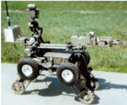
**Imagen 1.2** *Mini-Andros II* desarrollado por REMOTEC, parte de Northrop Grumman Corporation. <sup>[IMG 2]</sup>
