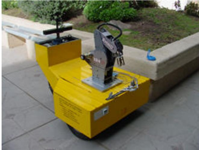
**Imagen 1.5** Sistema Autónomo Robot Móvil + Brazo Robótico desarrollado por el Grupo GIII en Argentina. <sup>[IMG 5]</sup>
