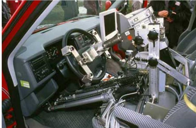
**Imagen 2.1** Robot *Klaus* desarrollado por VW para hacer las pruebas de sus vehículos. <sup>[IMG 6]</sup>
