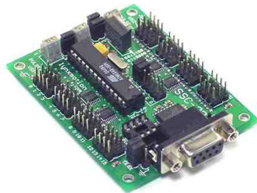
Figura 11. Tarjeta controladora de servos de 32 canales.
